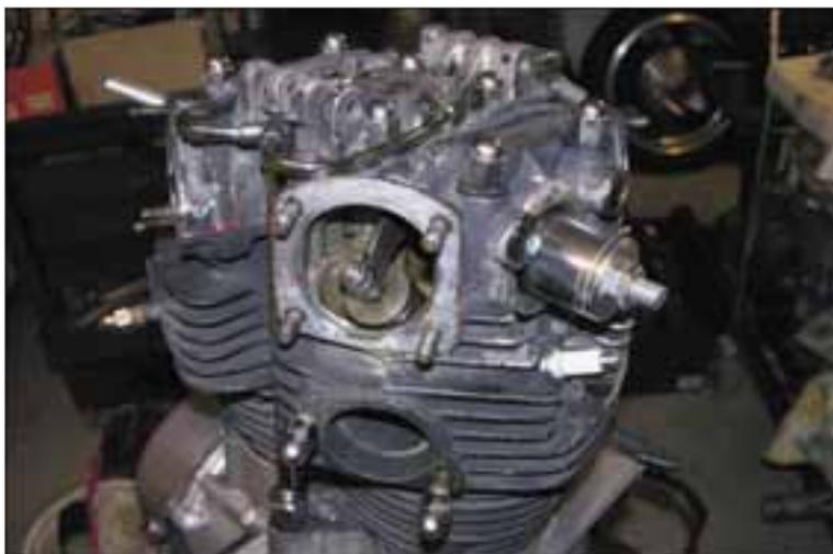
**Abb. 6-137:** Zylinderkopfdeckel aufsetzen, Ölsteigleitung montieren
