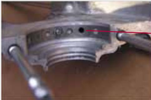
**Abb. 1-91:** Ölaustrittsöffnung aus dem Motorgehäuse
