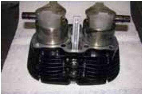
**Abb. 6-99:** Kolben in Laufbuchsen einsetzen, auf Pfeilmarkierung (vorne) achten
