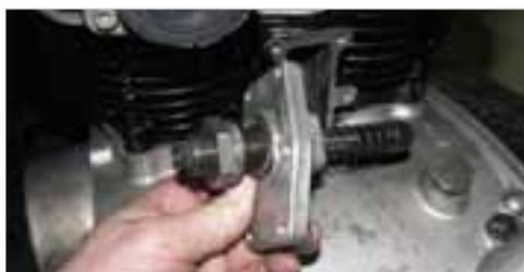
Abb. 6-143: Steuerkettenspanner montieren
