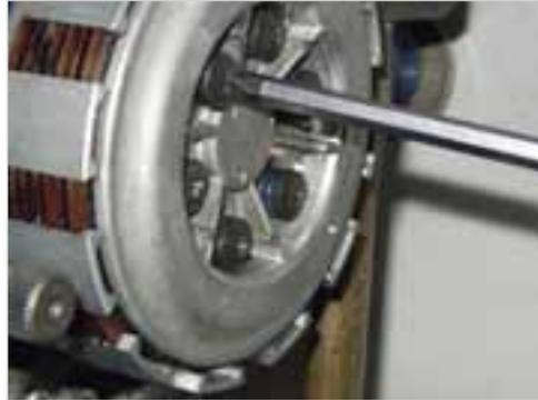
**Abb. 5-45:** Kupplungsdruckfedern demontieren (Detailaufnahme)
