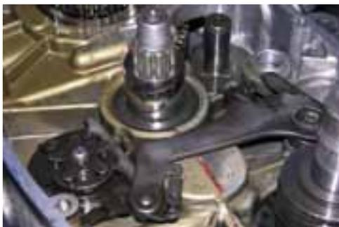
Abb. 6-46: Hülse auf Getriebeeingangswelle aufsetzen
