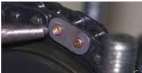
**Abb. 6-131:** Kettenschloss - linker Niet bereits vernietet
