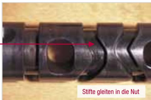
Abb. 1-53: Führungsnuten auf der Schaltwalze
