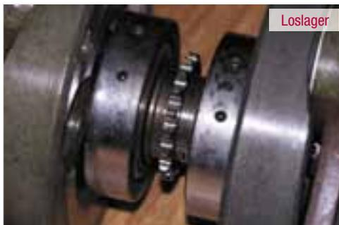
Abb. 1-7: Mittlere Lager der KW mit Antriebsritzel der Steuerkette
