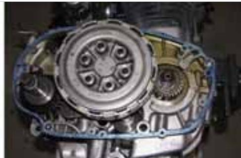
**Abb. 6-72:** Rechten Motorseitendeckel aufsetzen
