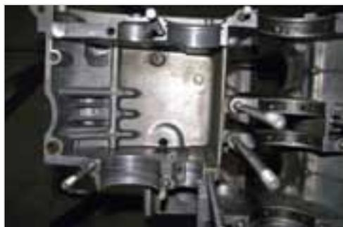
**Abb. 6-5:** Obere Gehäusehälfte (Getriebeseite)
