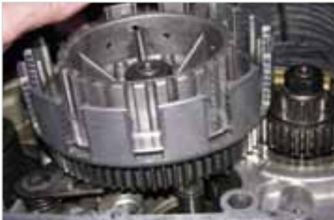
**Abb. 6-62:** Innen- und Außenteil der Kupplung
