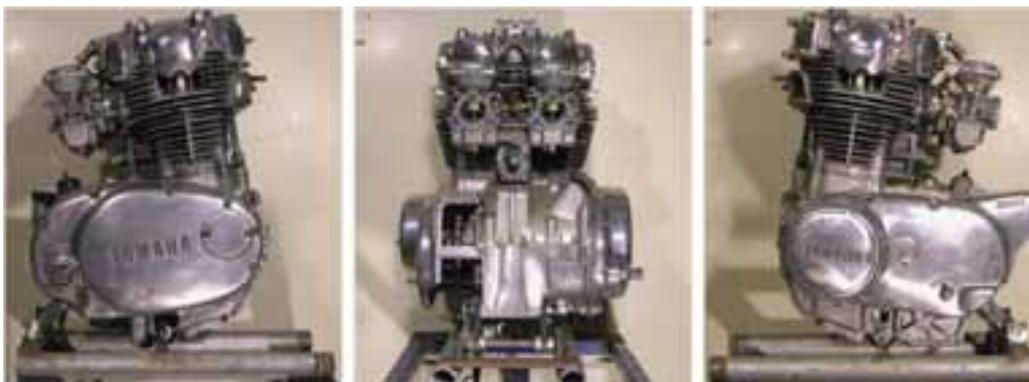
**Abb. 3-6:** Aus Rohren angefertigter Motorständer
