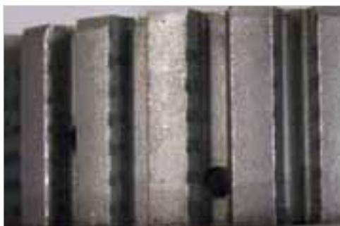
**Abb. 7-19:** Innerer Kupplungskorb mit Abdrücken der Blechscheiben (Detailvergrößerung)
