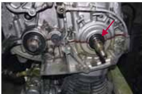
Abb. 6-23: Untere Gehäusehälfte aufgesetzt
