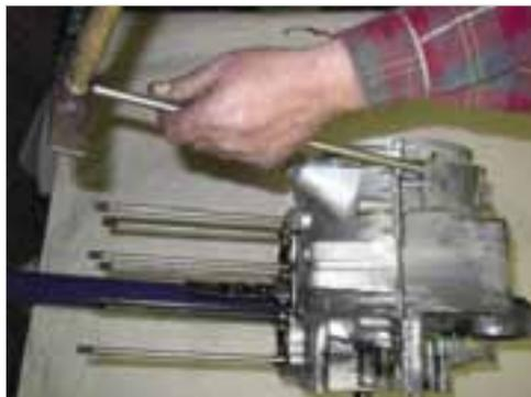
**Abb. 5-61:** Gehäusehälften trennen
