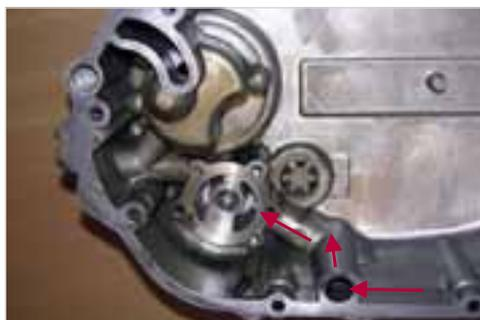
**Abb. 1-74:** Einbauort der Ölpumpe und zweiter Ölfilter im rechten Motorseitendeckel
