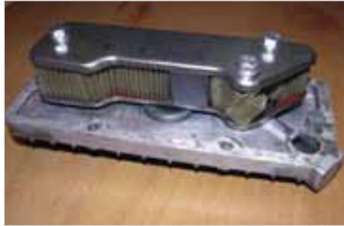
**Abb. 1-68:** Ölfilter mit der Grundplatte verschraubt
