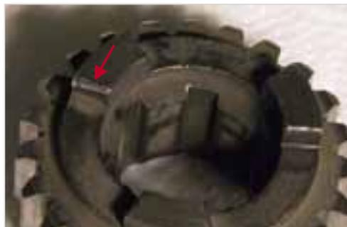
**Abb. 7-26:** Zahnrad des vierten Ganges auf der Getriebeausgangswelle
