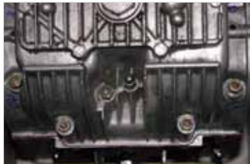
**Abb. 6-30:** Stehbolzen mit angeschriebenen Nummern in der Anziehreihenfolge
