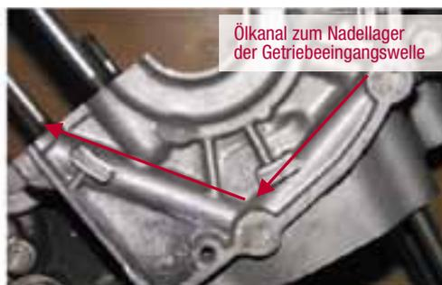
Abb. 1-105: Ölkanäle zu den Schmierstellen des Getriebes
