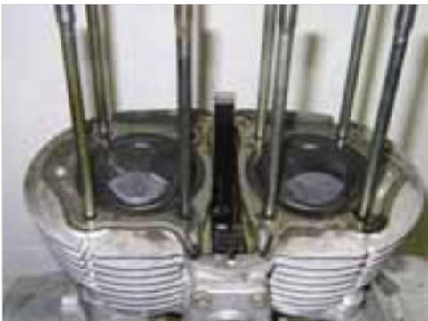
**Abb. 5-26:** Zylinder mit abgenommenem Zylinderkopf
