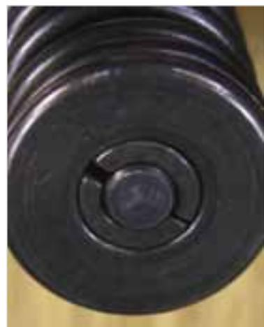
Abb. 1-29: Ventilteller mit Ventilkeilen
