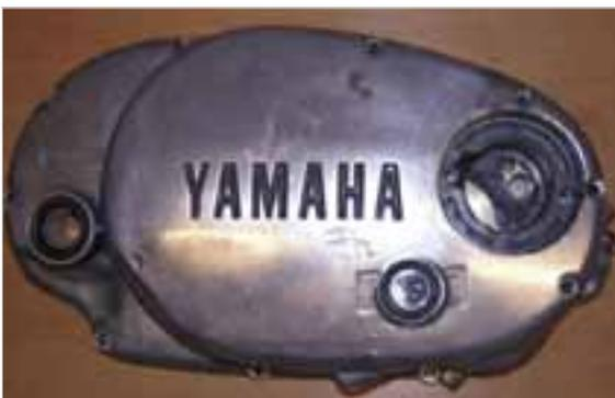
**Abb. 1-84:** Rechter Motorseitendeckel mit Öffnung für den Ölfilter
