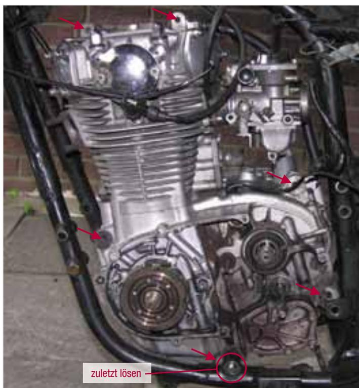
**Abb. 3-1:** Befestigungspunkte des Motors im Rahmen
