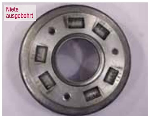
**Abb. 7-15:** Rückseite des Kupplungskorbes mit abgebauten Ruckdämpferfedern
