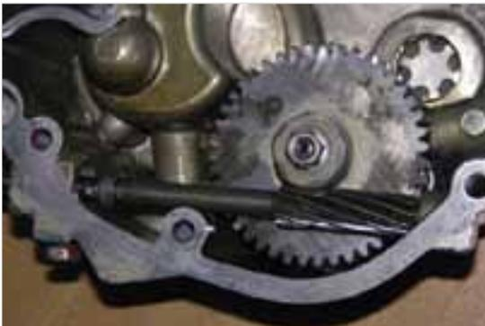
**Abb. 1-82:** Drehzahlmesserantrieb
