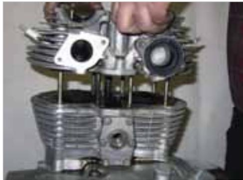
**Abb. 5-25:** Zylinderkopf abnehmen
