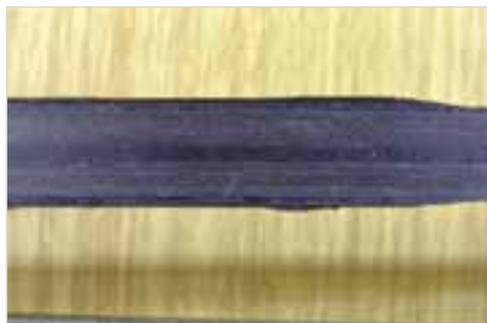
**Abb. 7-4:** Verschleißbild der Gleitflächen im Detail
