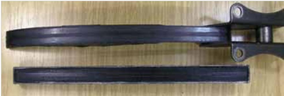
**Abb. 7-1:** Gleitflächen der Steuerkettenspannschienen
