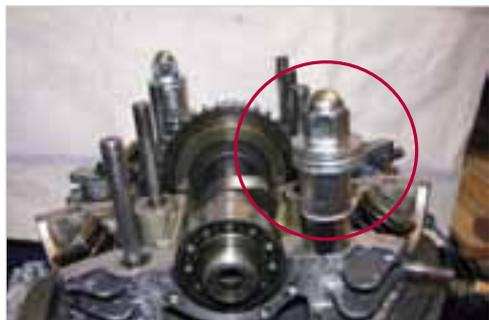
**Abb. 6-128:** Zylinderblock vorspannen, die Steuerkette ist sonst zu kurz um sie zu schließen
