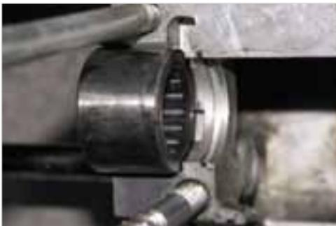
**Abb. 1-107:** Nadellager der Getriebeeingangswelle
