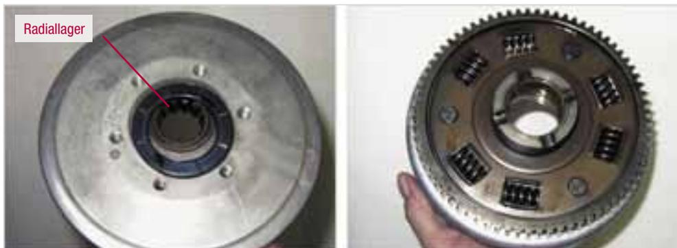
**Abb. 5-52:** Vorder- und Rückseite des Kupplungskorbes mit Radiallager
