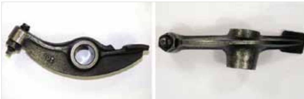
**Abb. 1-30:** Kipphebel mit Ventileinstellschraube
