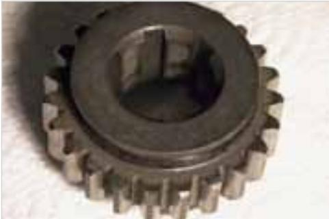
**Abb. 7-27:** Zahnrad des vierten Ganges auf der Getriebeausgangswelle
