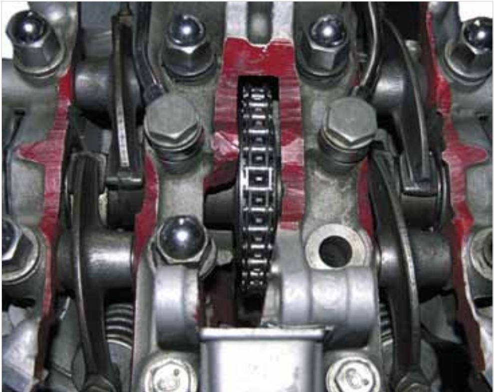
**Abb. 1-23:** Nockenwelle mit Ventiltrieb und Ventilen
