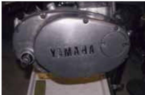
**Abb. 6-76:** Rechten Motorseitendeckel aufsetzen
