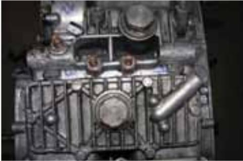
**Abb. 6-31:** Stehbolzen mit angeschriebenen Nummern in der Anziehreihenfolge
