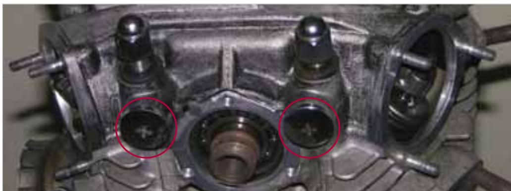
Abb. 1-26: Lagerung der Kipphebelwellen
