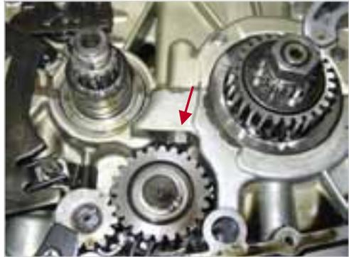
**Abb. 5-58:** Schraube hinter dem Kupplungskorb lösen
