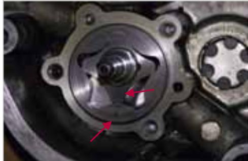
**Abb. 1-76:** Sicht auf die Ölpumpe, Innenseite
