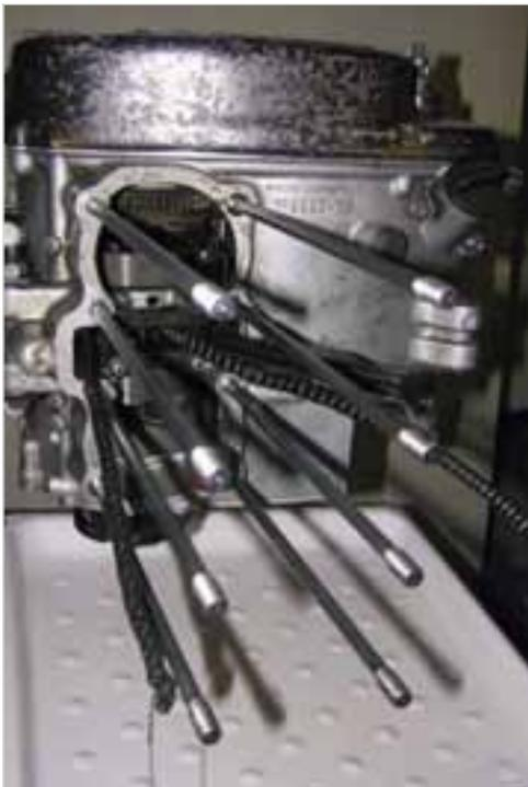
**Abb. 6-97:** Motor auf die Seite drehen
