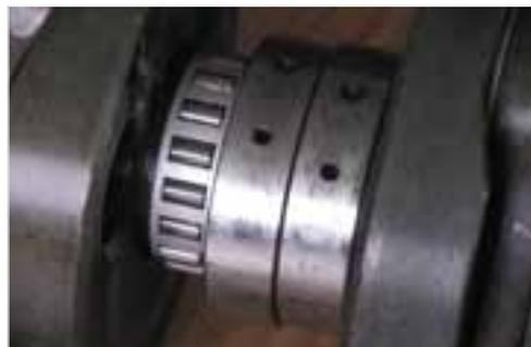
Abb. 1-8: Mittlere Lager der KW mit verschobenem Außenring des rechten Lagers
