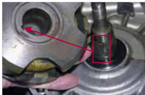
**Abb. 6-86:** Rotor mit Nut auf Scheibenfeder aufsetzen
