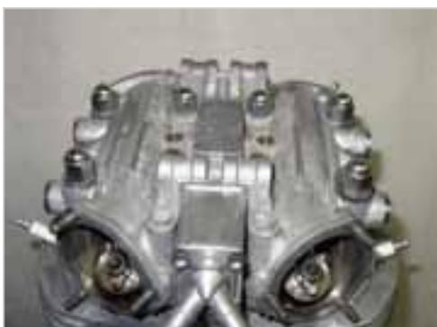
Abb. 5-14: Zylinderkopfschrauben lösen
