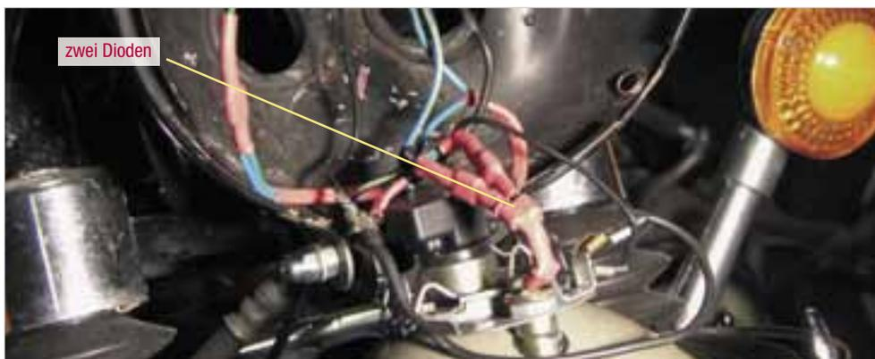
Abb. 8-3: Kabel zum Standlicht mit Dioden
