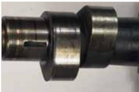
**Abb. 7-8:** Verschlissene Nocken im Detail
