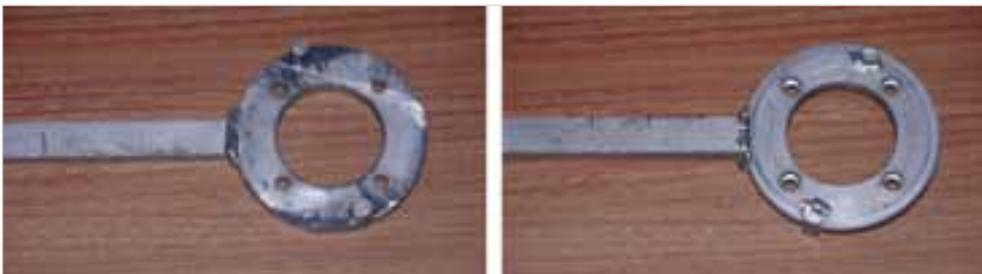
Abb. 2-3: Werkzeug zum Festhalten des Kettenritzels
