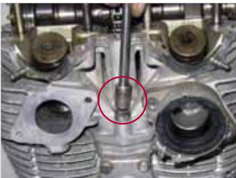
**Abb. 5-20:** Schraube zwischen den Ansaugflanschen lösen
