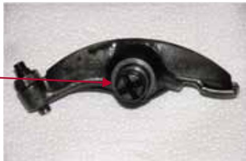
**Abb. 1-100:** Öleintritt in die Kipphebelwelle
