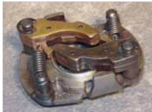
**Abb. 8-55:** Fliehkraftversteller abgebaut
