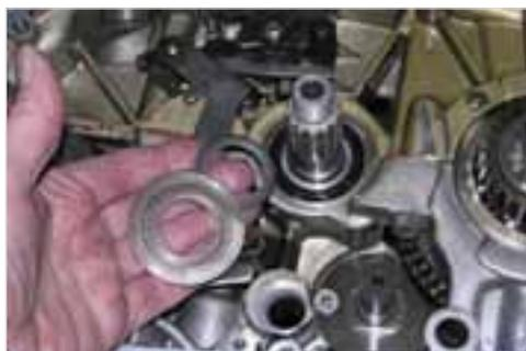
**Abb. 6-42:** Anlaufscheiben der Kupplung
