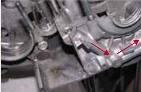
**Abb. 1-106:** Schmierung des Nadellagers der Getriebeeingangswelle
