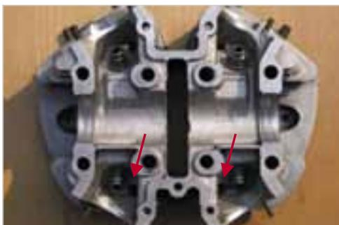
Abb. 1-103: Öl Ablaufbohrungen im Zylinderkopf
