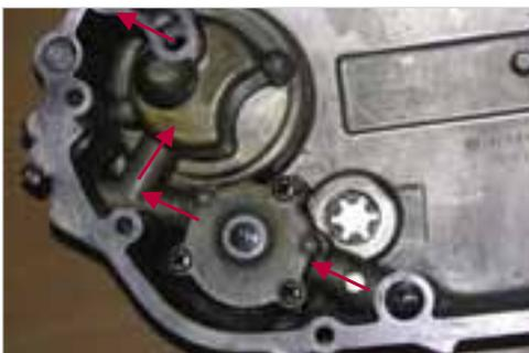
**Abb. 1-78:** Ölpumpe und Ölfilter in zusammengebautem Zustand
