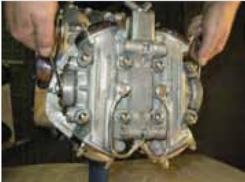
**Abb. 5-6:** M6-Mutter lösen
