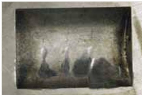
**Abb. 7-17:** Vertiefung für Ruckdämpferfeder mit Einlaufspuren
