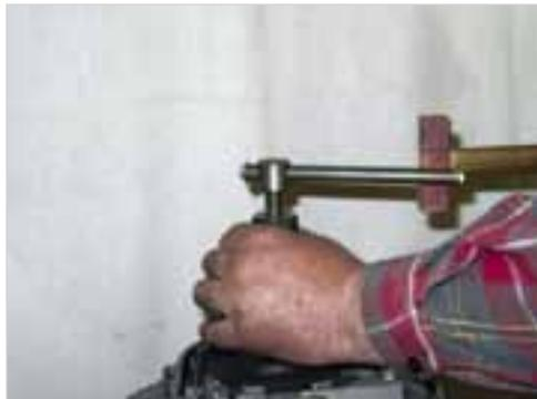
**Abb. 5-35:** Rotor abziehen
