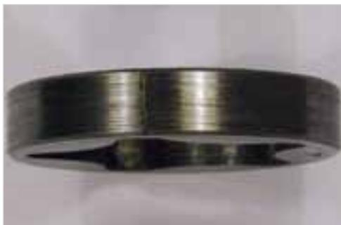
**Abb. 7-34:** Außenteil der Ölpumpe mit Riss
