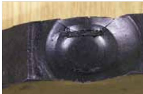
**Abb. 7-3:** Kugelkalotte der Druckstange des Steuerkettenspanners
