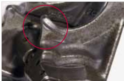
**Abb. 7-30:** Schaltgabel zum Schalten des ersten Ganges mit Materialabrieb an den Enden
