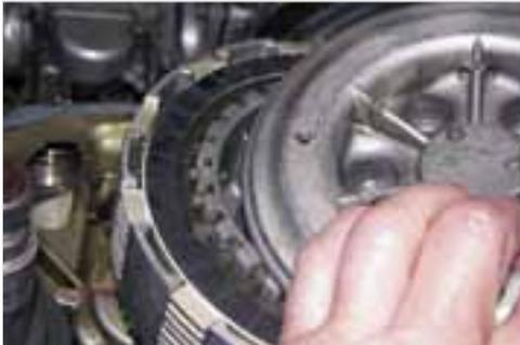
Abb. 6-68: Druckplatte aufsetzen
