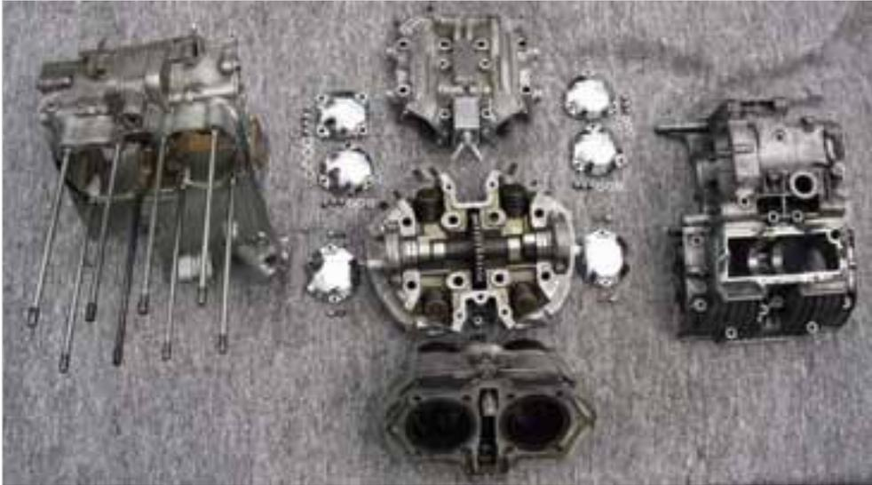
Abb. 4-1: Gehäusehälften, Zylinderkopf mit Nockenwelle und Zylinder
