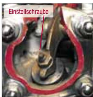
**Abb. 1-33:** Einblick in das linke Auslaßventilgehäuse
