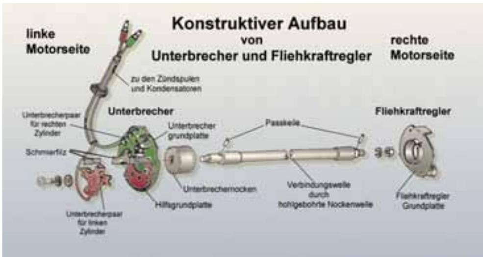
Abb. 8-52: Aufbau des Unterbrechers und des Fliehkraftreglers
