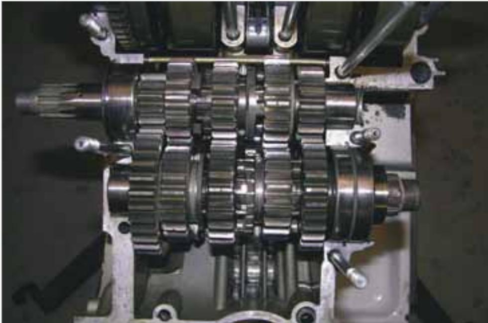
**Abb. 6-14:** Getriebewellen einlegen
