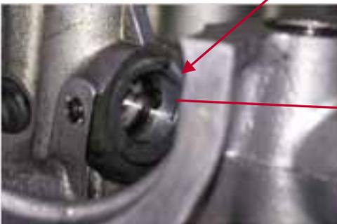
**Abb. 1-99:** Austrittsöffnung des Öls aus dem Gehäuse
