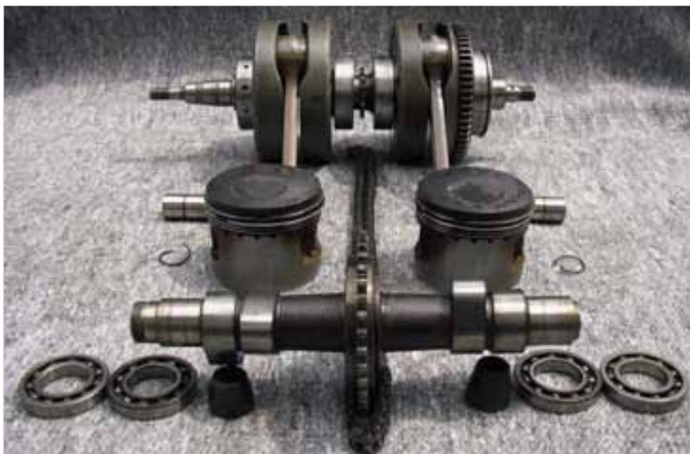
**Abb. 4-4:** Kurbelwelle, Kolben, Steuerkette und Nockenwelle
