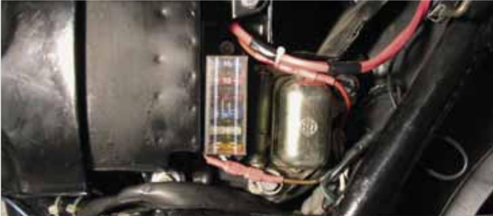
**Abb. 8-2:** Sicherungskasten für Flachsicherungen
