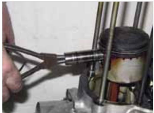
**Abb. 5-31:** Kolbenbolzen herausziehen
