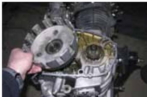
Abb. 6-47: Kupplungskorb auf Getriebeeingangswelle aufsetzen
