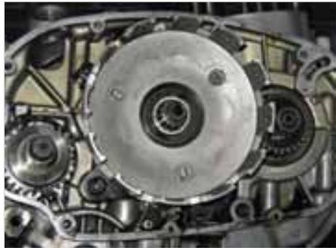
**Abb. 5-51:** Anlaufscheiben und Radiallager abnehmen
