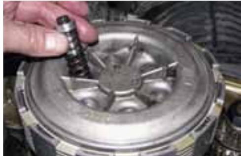
Abb. 6-69: Druckfedern einbauen
