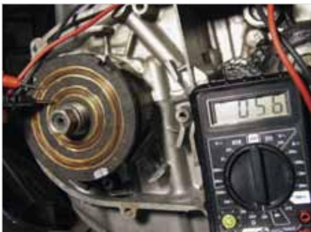
**Abb. 8-27:** Prüfung des Rotors
