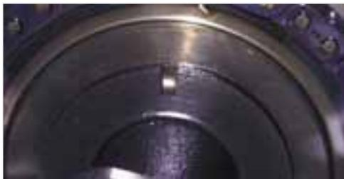
**Abb. 6-129:** OT Markierung der Nockenwelle muss **senkrecht** stehen
