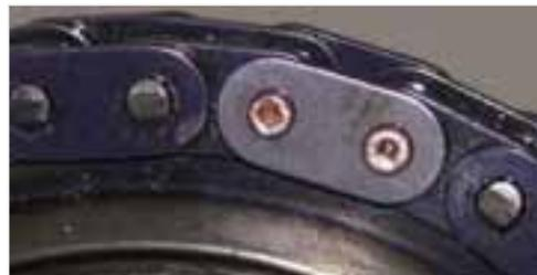
**Abb. 6-132:** Kettenschloss - linker Niet bereits vernietet
