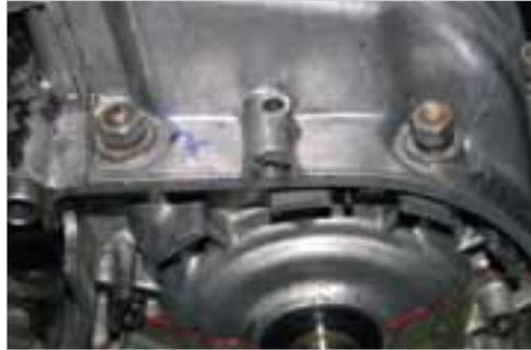
**Abb. 6-32:** Stehbolzen mit angeschriebenen Nummern in der Anziehreihenfolge
