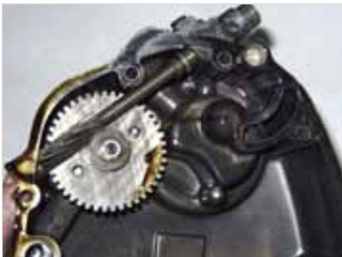
**Abb. 5-40:** Ölpumpe und Drehzahlmesserantrieb
