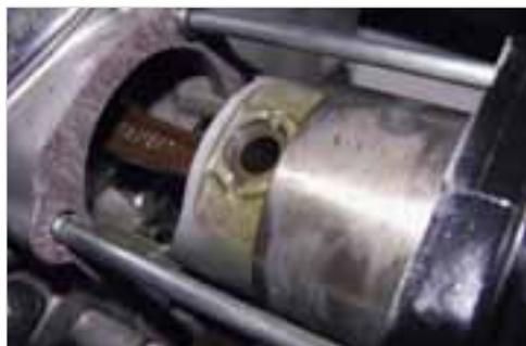
**Abb. 6-106:** Kolbenbolzen einführen und sichern
