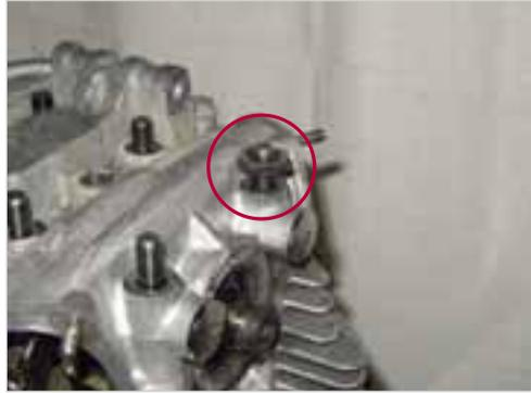
**Abb. 5-17:** Die äußeren Scheiben sind gummiert
