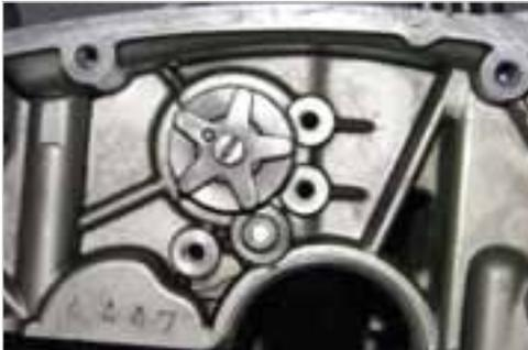
**Abb. 6-10:** Eingesetzte Schaltwalze
