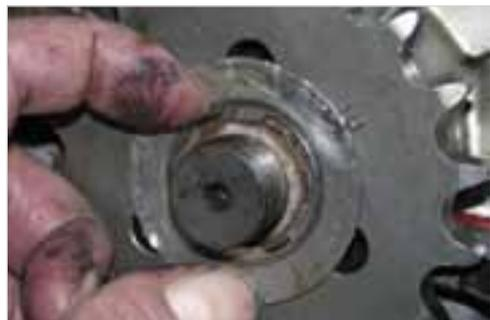
Abb. 6-80: Sicherungsblech einsetzen
