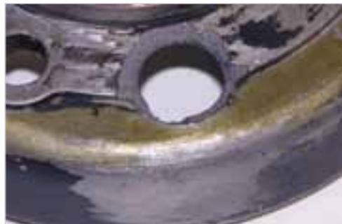
Abb. 6-142: Angerissenes Gehäuse im Bereich der Senkung der Befestigungsschraube infolge eines Montagefehlers
