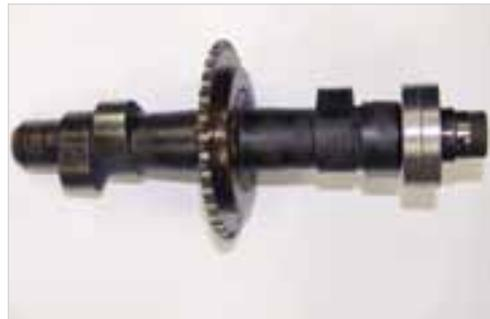
**Abb. 7-7:** Nockenwelle mit wegen Öl­mangel verschlissenen Nocken
