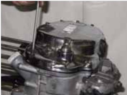
**Abb. 5-38:** Rechten Seitendeckel demontieren
