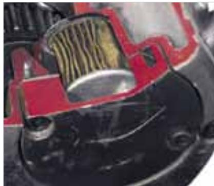
**Abb. 1-83:** Ölfilter im rechten Motorseitendeckel
