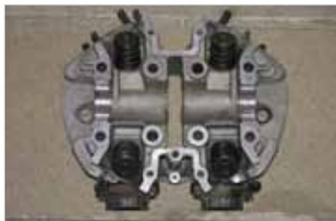
**Abb. 6-122:** Ventile fertig montiert
