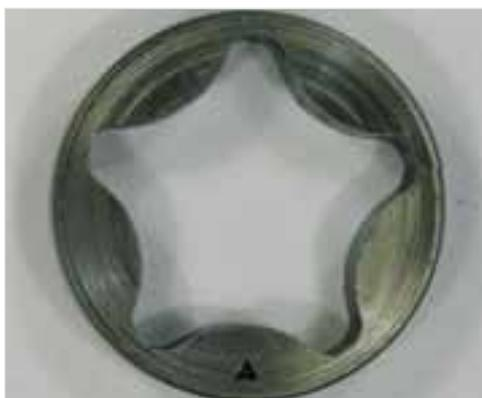
Abb. 7-32: Äußerer Rotor der Ölpumpe
