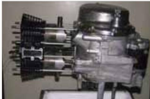
**Abb. 6-104:** Zylinder auf Stehbolzen aufschieben
