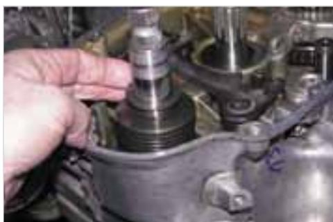
**Abb. 6-44:** Anlaufscheibe auf Kickstartermechanismus aufsetzen
