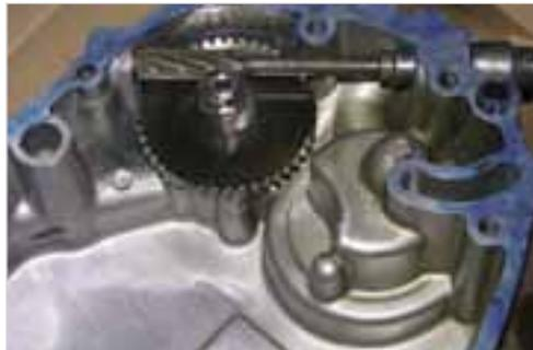
**Abb. 6-74:** Flüssige Dichtung
