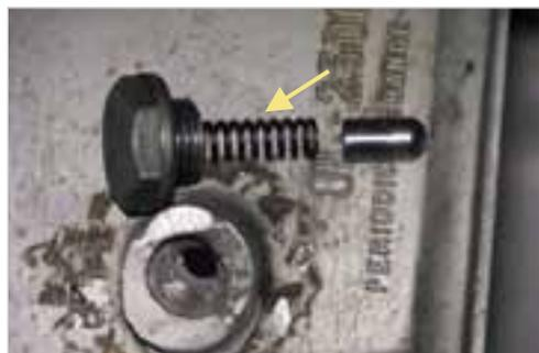
**Abb. 6-13:** Arretierbolzen für 1. Gang einsetzen
