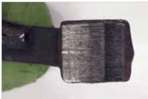
**Abb. 7-11:** Dazugehörige Gleitfläche eines Kipphebels
