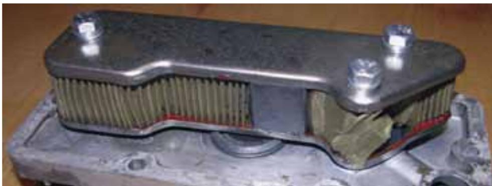
**Abb. 7-31:** Ölfilter mit eingerissenem Filtersieb.
