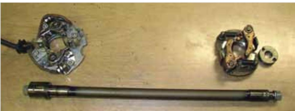
**Abb. 5-10:** Einzelteile von Unterbrecher und Fliehkraftregler
