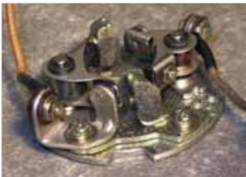
Abb. 8-45: Fliehkraftregler ausgebaut
