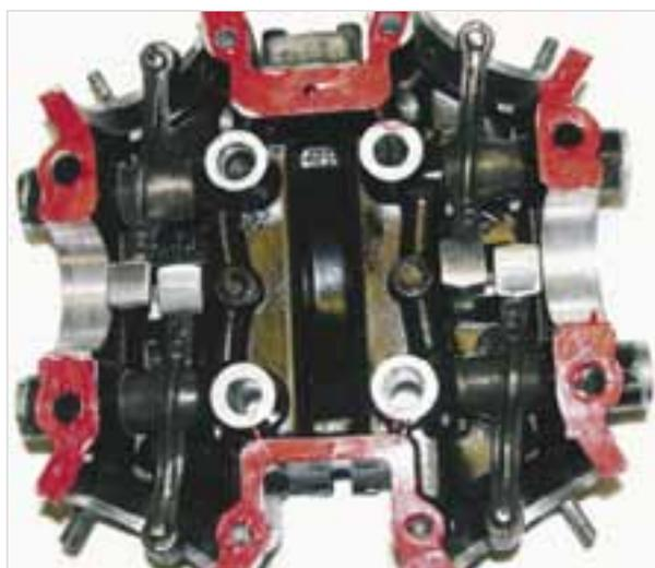
**Abb. 1-32:** Sicht in das Oberenteil der Zylinderkopfes
