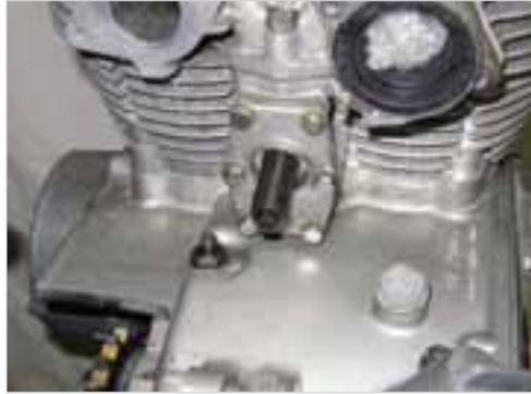
**Abb. 5-23:** Steuerkettenspanner abbauen
