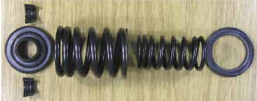
Abb. 1-27: Ventilfedern
