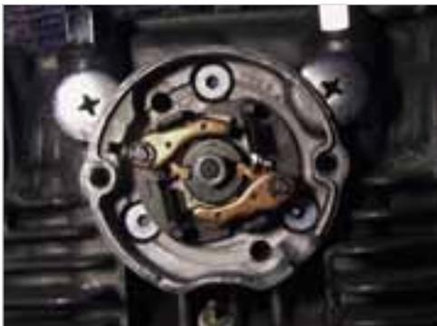
**Abb. 8-54:** Fliehkraftversteller angebaut
