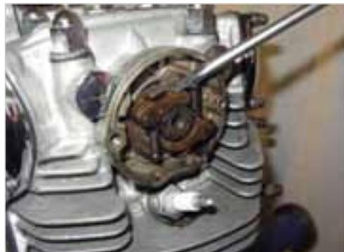
**Abb. 5-9:** Fliehkraftregler ausbauen
