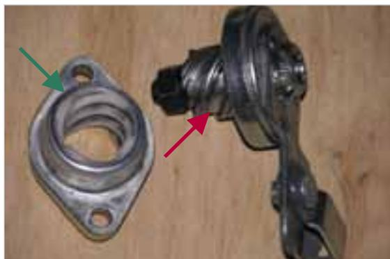
Abb. 1-40: Ausrückmechanismus der Kupplung im demontierten Zustand
