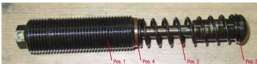
Abb. 1-22: Spannmechanismus
