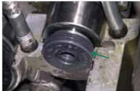
**Abb. 6-20:** Getriebeeingangswelle mit Dichtring der Kupplungsdruckstange
