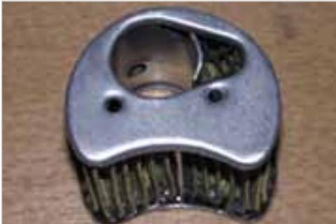
Abb. 1-86: Zweiter Ölfilter hinter der Ölpumpe
