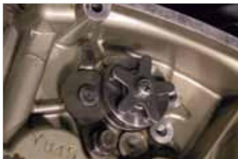
**Abb. 5-69:** Feder aushängen und Sicherungsblech entfernen
