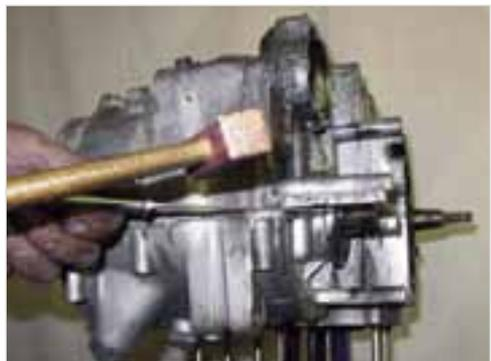
**Abb. 5-62:** Gehäusehälften trennen
