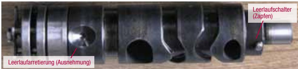
Abb. 1-60: Schaltwalze mit Betätigung für Leerlaufschalter und Vertiefung für Bolzen zur Leerlaufarretierung
