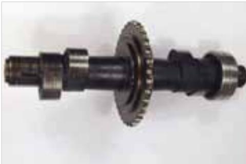
**Abb. 7-6:** Nockenwelle mit wegen Öl­mangel verschlissenen Nocken.
