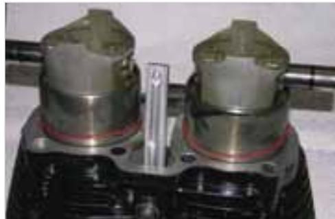
**Abb. 6-100:** Dichtringe aufziehen, Kolbenbolzen von außen einschieben
