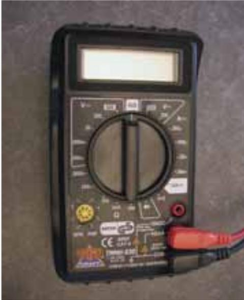
**Abb. 8-24:** Vielfachmessgerät (Voltmeter, Ohmmeter)
