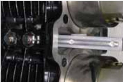
**Abb. 6-103:** vordere Steuerkettenspannschiene montieren
