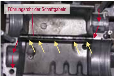
**Abb. 1-109:** Detail: Ölleitung durch das Führungsrohr der Schaltgabeln
