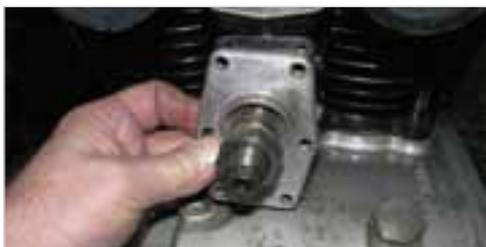
Abb. 6-145: Steuerkettenspanner montieren
