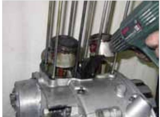
**Abb. 5-29:** Kolben erwärmen
