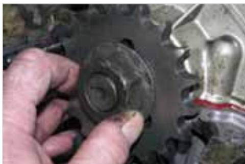
**Abb. 6-82:** Ritzelmutter richtig montieren
