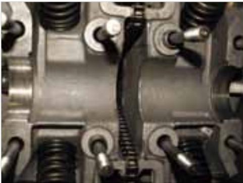
**Abb. 5-24:** Steuerkette sichern, so dass diese nicht herunterrutscht
