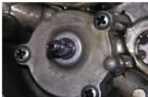
**Abb. 1-79:** Ölpumpe mit Antriebswelle mit Passkeil
