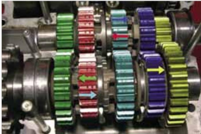
**Abb. 1-45:** Zuordnung der Gänge zu den Zahnradpaaren, Schaltvorgänge
