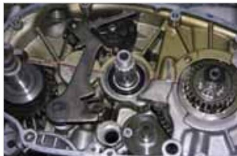
Abb. 6-40: Schaltgabel und Schaltwalze verbinden
