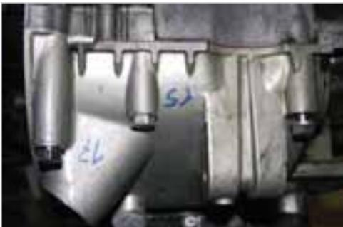
**Abb. 6-35:** Stehbolzen mit angeschriebenen Nummern in der Anziehreihenfolge
