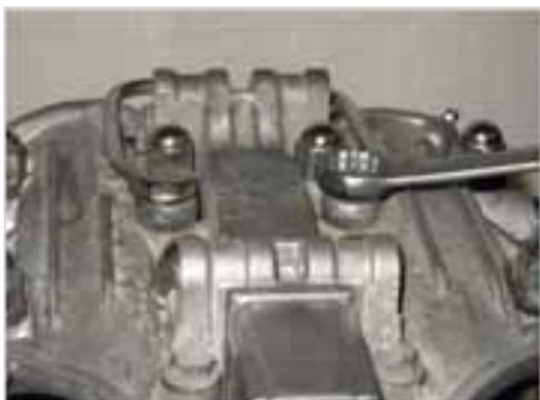
Abb. 5-13: Ölsteigleitung abbauen – zuerst oben lösen und darauf achten, daß die Ölsteigleitung nicht verdreht und dabei beschädigt wird.
