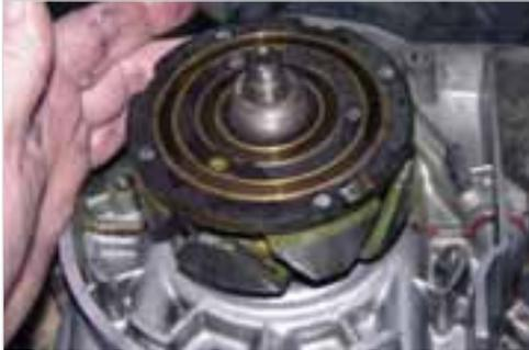
**Abb. 6-87:** Rotor mit Nut auf Keil aufsetzen
