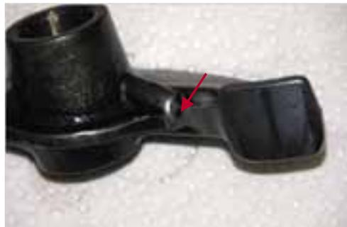
**Abb. 1-102:** Ölaustrittsöffnung und Gleitfläche des Kipphebels
