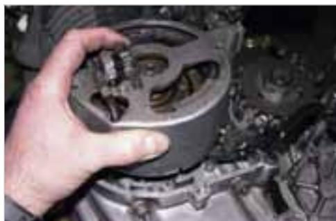
**Abb. 6-92:** Stator aufsetzen
