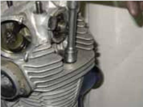
**Abb. 5-18:** Schrauben in der Nähe der Zündkerzen lösen
