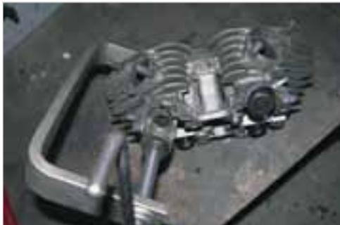
**Abb. 6-119:** Ventilkeile montieren
