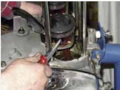
**Abb. 5-30:** Sicherungsring entfernen
