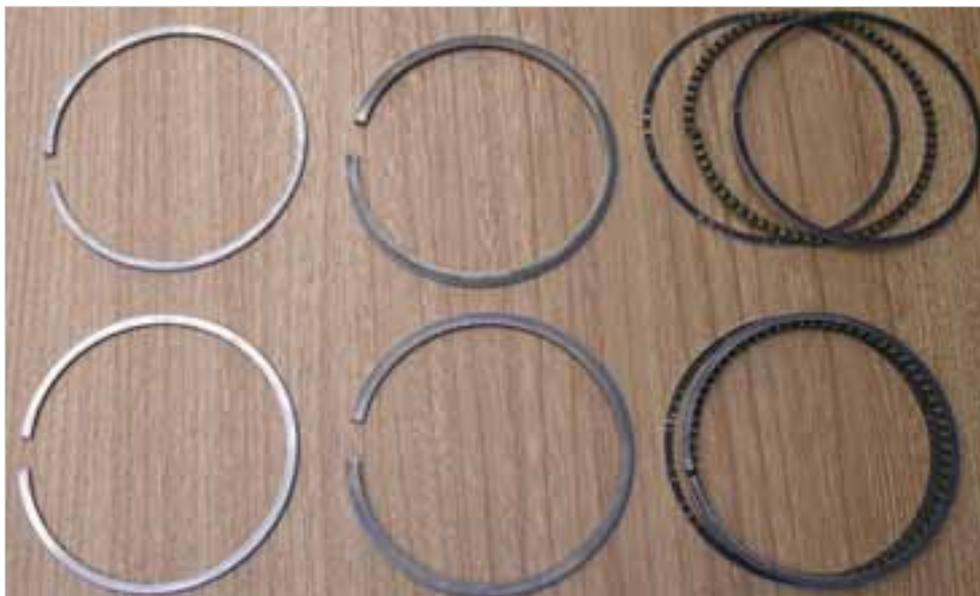
**Abb. 1-15:** Kolbenringe
