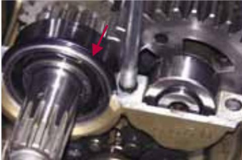
**Abb. 6-15:** Lager auf der Kupplungsseite mit Sicherungsring
