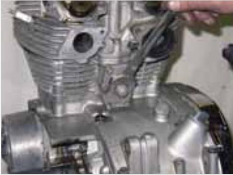
**Abb. 5-22:** Steuerkettenspanner abbauen
