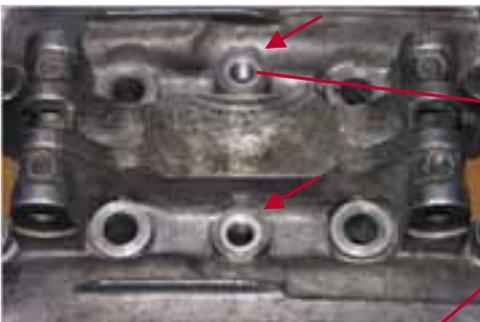
**Abb. 1-97:** Anschlüsse der Ölsteigleitung
