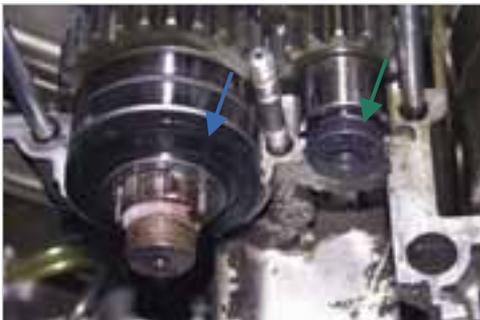
**Abb. 6-19:** Lager der Getriebeausgangswelle mit Simmerring
