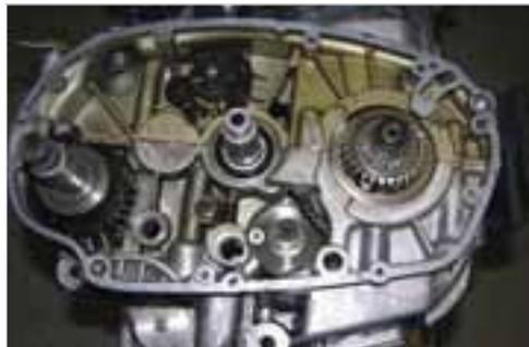
**Abb. 6-36:** Montierte Gehäusehälften
