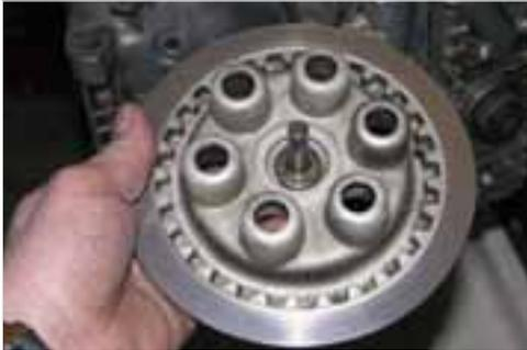
Abb. 6-66: Druckpils der Kupplungsdruckstange
