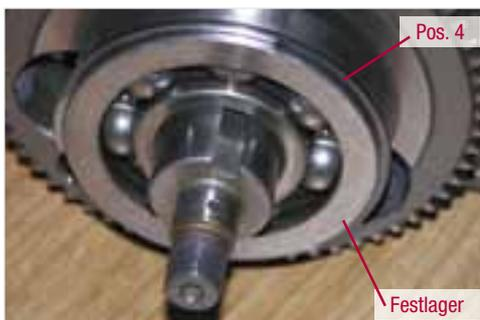
**Abb. 1-10:** Abtriebsseite der Pleuellager mit rechtem Hauptlager
