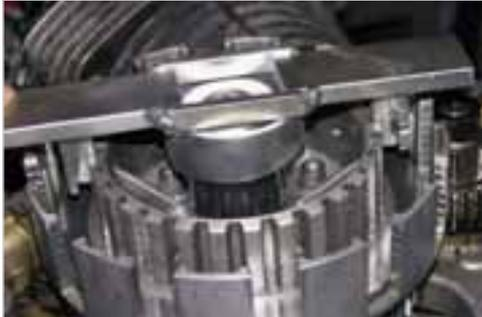
**Abb. 6-60:** Hilfswerkzeug zum Halten des inneren Kupplungskorbes
