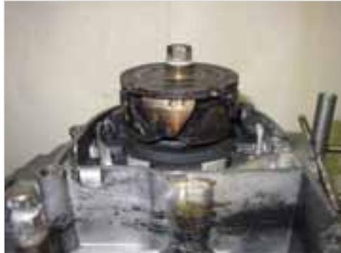
**Abb. 5-33:** Stator abgebaut
