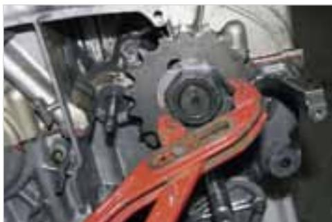
**Abb. 6-84:** Sicherungsblech umbiegen
