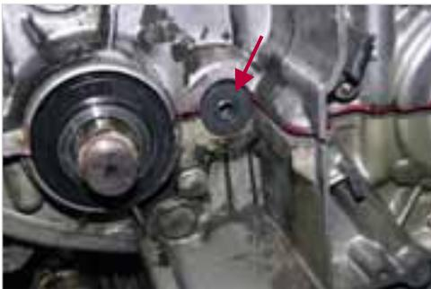
**Abb. 6-27:** Getriebewellen mit Wellendichtungen
