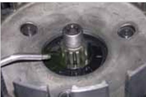
**Abb. 6-52:** Axiallager ölen
