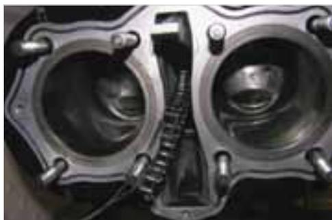
**Abb. 6-109:** Steuerkette durch Kettenschacht ziehen und sichern
