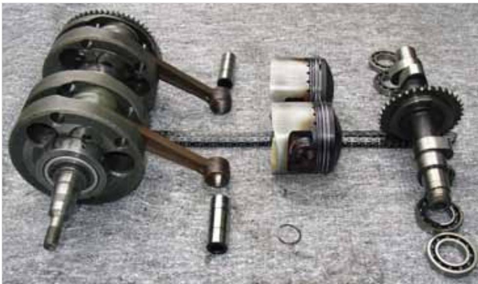
**Abb. 4-2:** Kurbelwelle, Kolben, Steuerkette und Nockenwelle
