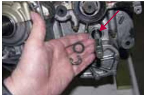
Abb. 6-38: Axiale Sicherung der Schaltwelle
