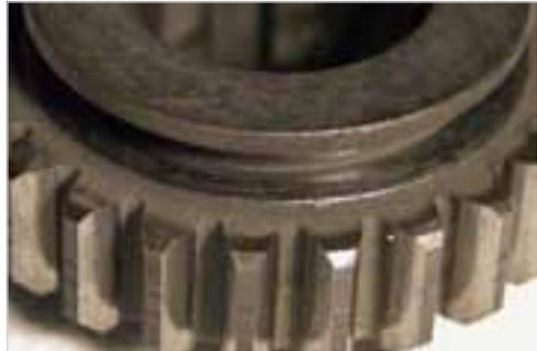
**Abb. 7-28:** Zahnrad des vierten Ganges auf der Getriebeausgangswelle
