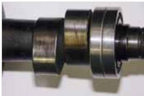
**Abb. 7-9:** Verschlissene Nocken im Detail
