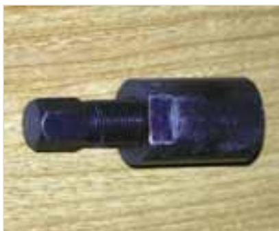
Abb. 2-6: Abzieher für den Lichtmaschinenrotor
