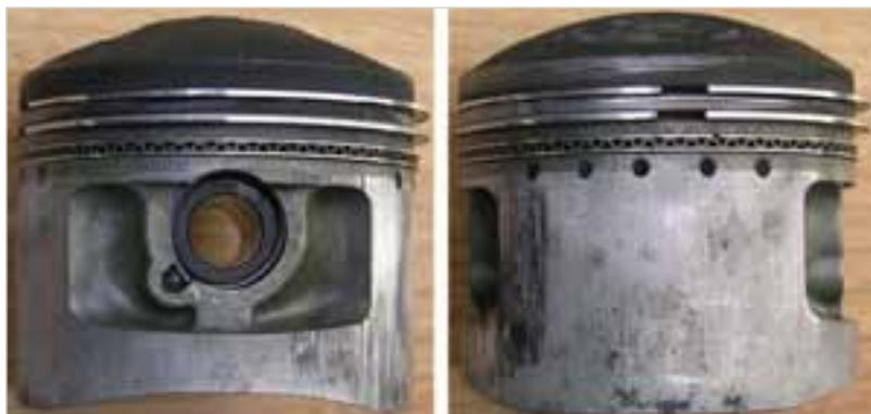
Abb. 1-14: Kolben mit eingesetztem Kolbenbolzen und Sicherungsring
