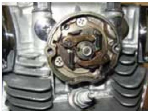
Abb. 5-5: Fliehkraftregler
