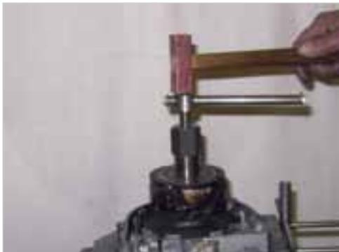
**Abb. 5-34:** Rotor abziehen
