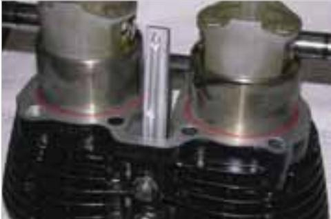
**Abb. 6-101:** Steuerkettenspannschiene montieren, nach Montage der Steuerkette ausrichten
