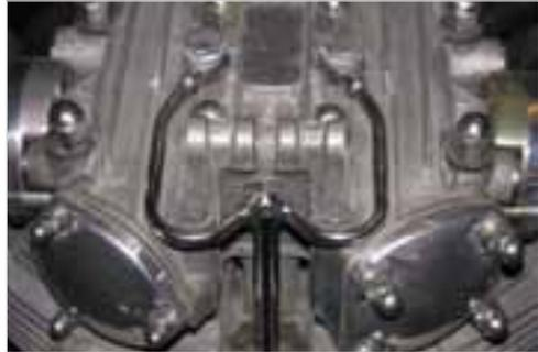
**Abb. 1-96:** Anschluss Ölsteigleitung / Zylinderkopf
