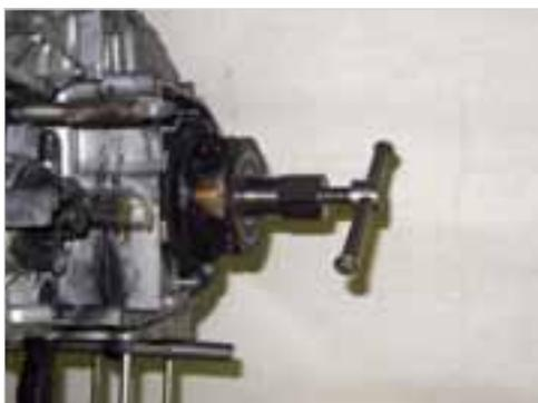
**Abb. 5-36:** Rotor abziehen
