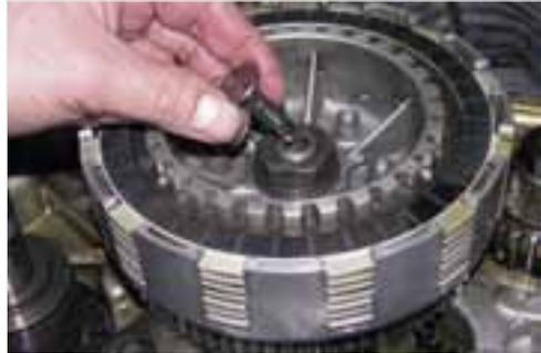
Abb. 6-67: Druckpils der Kupplungsdruckstange
