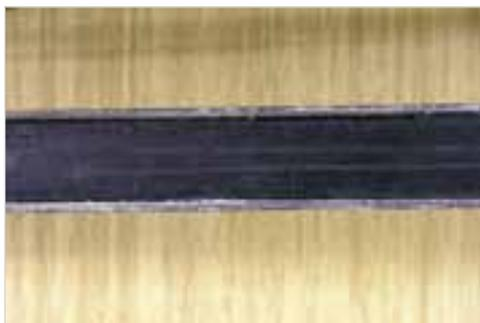
**Abb. 7-5:** Verschleißbild der Gleitflächen im Detail
