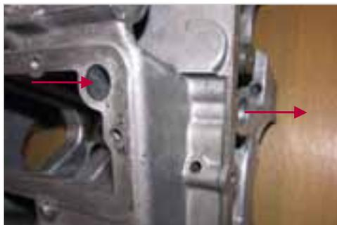
**Abb. 1-71:** Ölkanal zwischen Ölfiltergrundplatte und rechtem Seitendeckel
