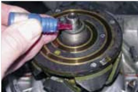
**Abb. 6-89:** Flüssige Dichtung aufbringen
