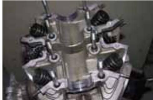
**Abb. 6-124:** Zylinderkopf bereit zur Montage der Nockenwelle
