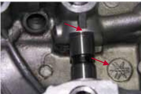
**Abb. 1-101:** Lagerung der Kipphebelwelle im Gehäuse
