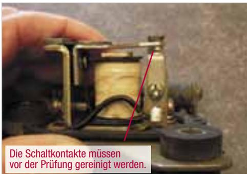
Die Schaltkontakte müssen vor der Prüfung gereinigt werden.
