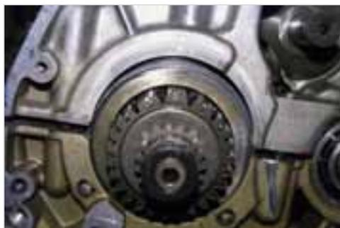
Abb. 6-26: Rechtes Kurbelwellenlager mit Sicherungsring
