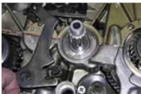
**Abb. 6-43:** Anlaufscheiben der Kupplung montiert
