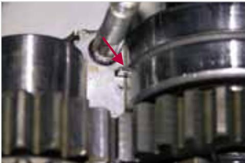
**Abb. 6-17:** Lager auf der Abtriebsseite mit Sicherungsring
