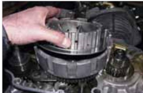
**Abb. 6-57:** Innenteil der Kupplung einsetzen
