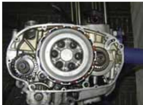
**Abb. 5-41:** Kickstartermechanismus und Kupplung
