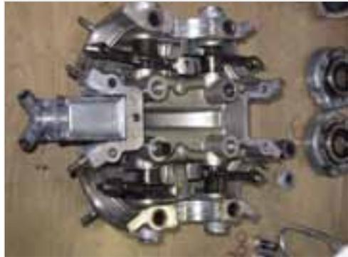
**Abb. 5-19:** Zylinderkopfdeckel abnehmen
