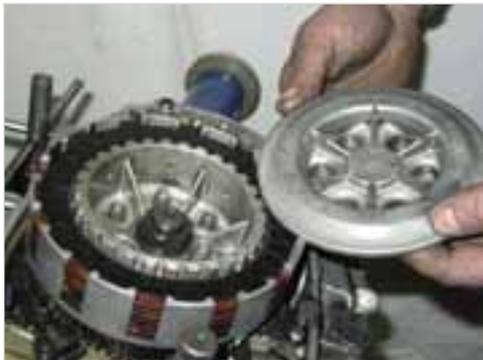
**Abb. 5-46:** Druckplatte abnehmen
