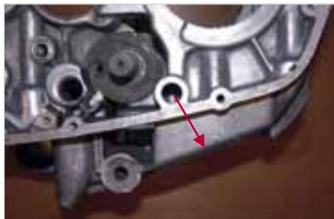
**Abb. 1-72:** Austrittsöffnung im unteren Motorgehäuseteil
