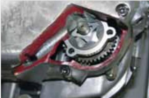
**Abb. 1-76:** Sicht auf die Ölpumpe, Außenseite
