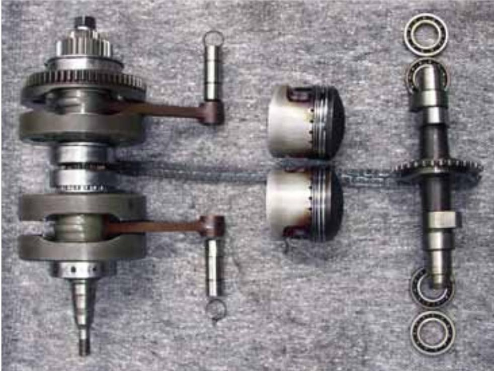
**Abb. 4-3:** Kurbelwelle, Kolben, Steuerkette und Nockenwelle
