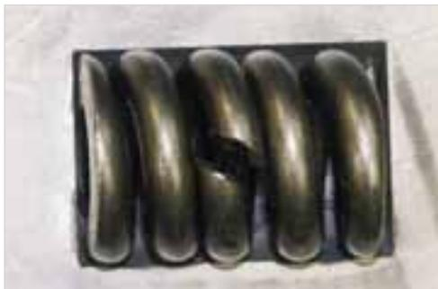
**Abb. 7-16:** Gebrochene Ruckdämpferfeder
