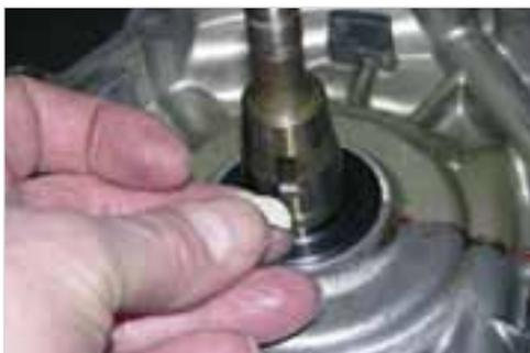
**Abb. 6-85:** Scheibenfeder für Rotor in die Nut im linken Kurbelwellenstumpf einsetzen
