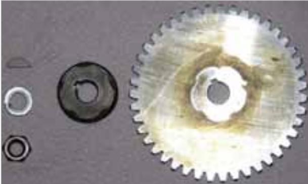
**Abb. 1-80:** Antriebszahnrad der Ölpumpe und Schneckenantrieb des Drehzahlmessers
