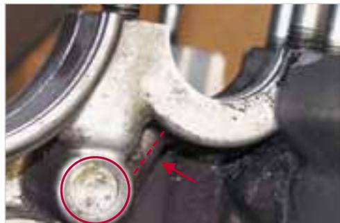
**Abb. 1-108:** Ölleitung durch das Führungsrohr der Schaltgabeln
