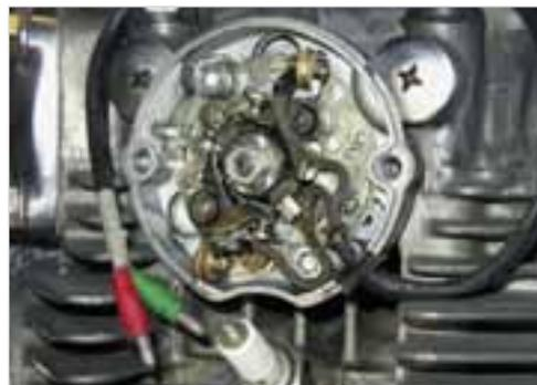
Abb. 8-46: Fliehkraftregler eingebaut
