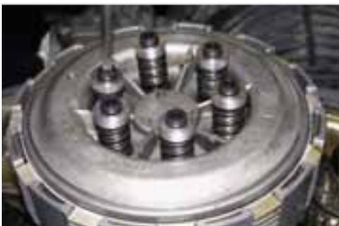
Abb. 6-70: Druckfedern einbauen
