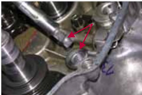
Abb. 6-37: Montage der Schaltwelle
