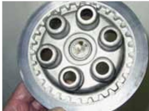
**Abb. 5-47:** Rückseite der Druckplatte
