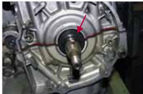
**Abb. 6-28:** Kurbelwellenlager mit Wellendichtring auf der Lichtmaschinen-seite
