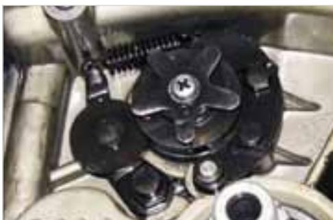
**Abb. 5-68:** Schaltwalze ausbauen
