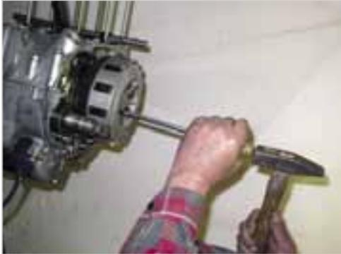
**Abb. 5-44:** Kupplungsdruckfedern demontieren
