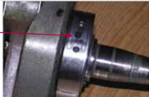
**Abb. 1-92:** Öleintrittsöffnung in ein Kurbelwellenlager
