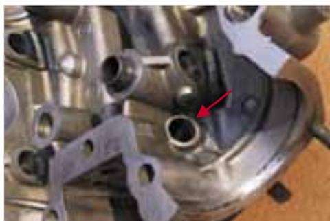
Abb. 1-104: Entlüftungsbohrung im Zylinderkopf
