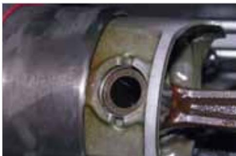
**Abb. 6-107:** Kolbenbolzen einführen und sichern (Detail)
