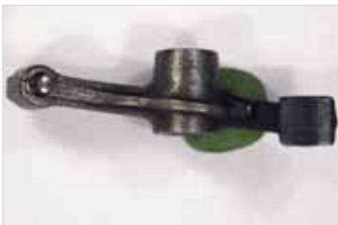
**Abb. 7-10:** Dazugehörige Gleitfläche eines Kipphebels
