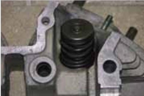
**Abb. 6-123:** Ventil fertig montiert
