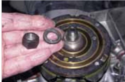
**Abb. 6-88:** Rotor mit Federring und Mutter
