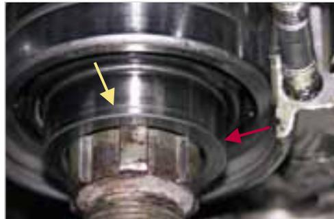
**Abb. 6-18:** Lager der Getriebeausgangswelle
