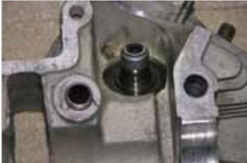
**Abb. 6-117:** Ventilschaftdichtung aufsetzen
