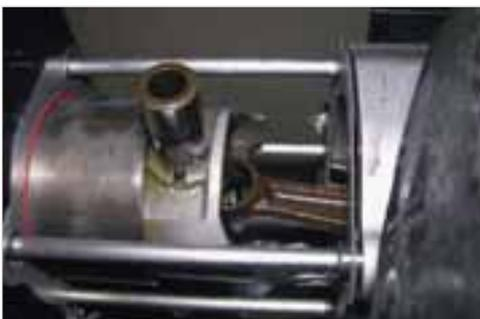
**Abb. 6-105:** Pleuelagen in Kolben einführen
