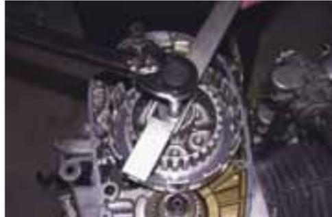
**Abb. 6-61:** Zentralmutter anziehen (80 Nm), mit Hilfswerkzeug gegenhalten
